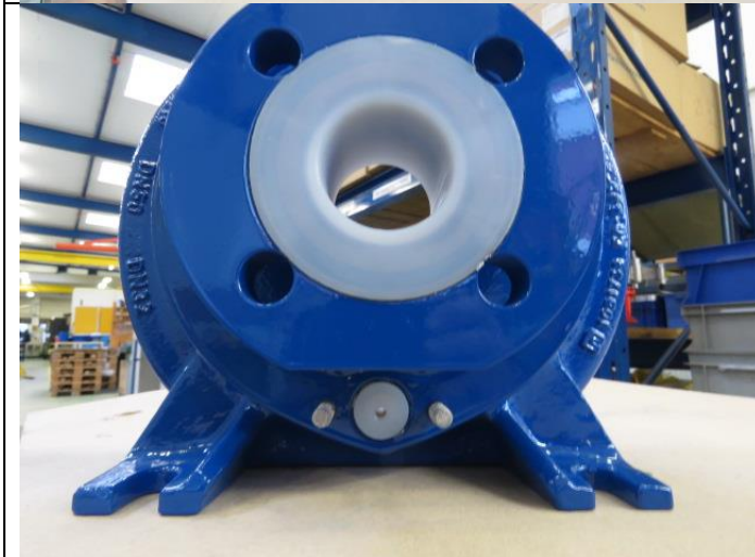
Bouchon de vidange MKPL: démonté
