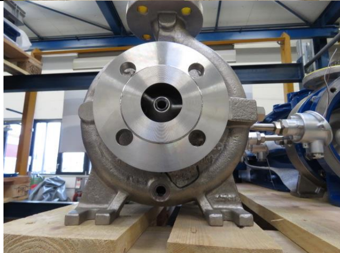
Bouchon de vidange MKP: démonté
