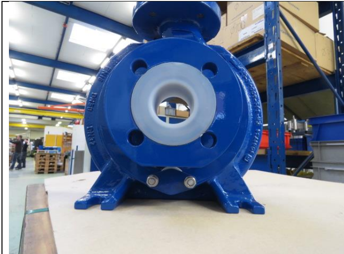
Bouchon de vidange MKPL: monté (position normale)
