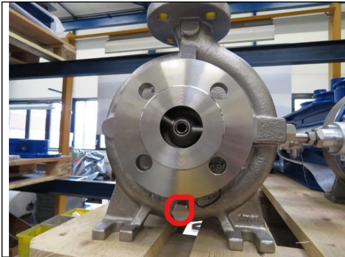
Bouchon de vidange MKP: monté (position normale)
