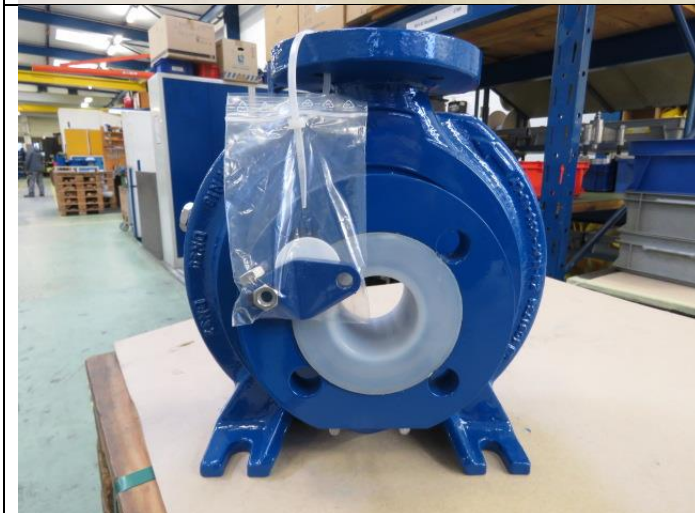
Bouchon de vidange MKPL: démonté, mais attaché à la pompe.
