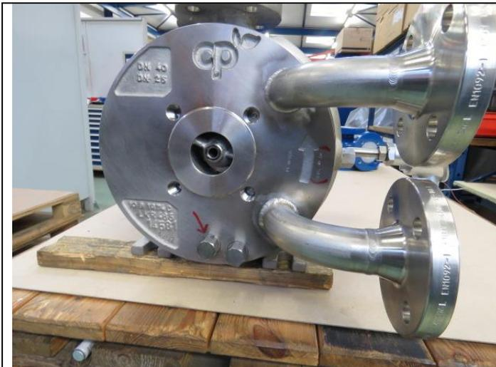
Entleerungsstopfen bei MKP mit Heizgehäuse mit Heizflanschen: Normalsituation, montiert.
