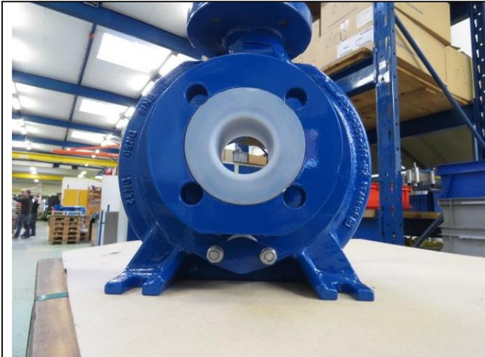
Entleerungsstopfen bei MKPL: Normalsituation, montiert.
