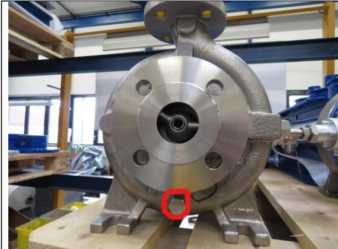
Entleerungsstopfen bei MKP: Normalsituation, montiert.
