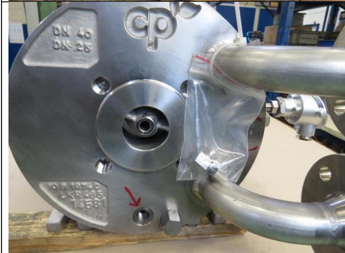
Entleerungsstopfen bei MKP mit Heizgehäuse mit Heizflanschen: lose mitgeliefert; an Pumpe befestigt.
