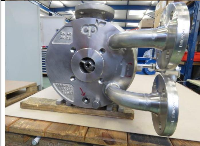
Entleerungsstopfen bei MKP mit Heizgehäuse mit Heizflanschen: demontiert.
