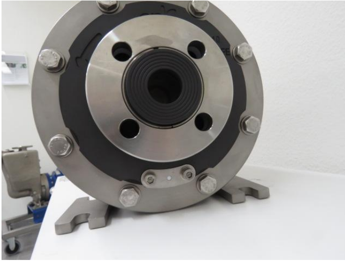
Bouchon de vidange pour MSKP: Situation normale, monté.
