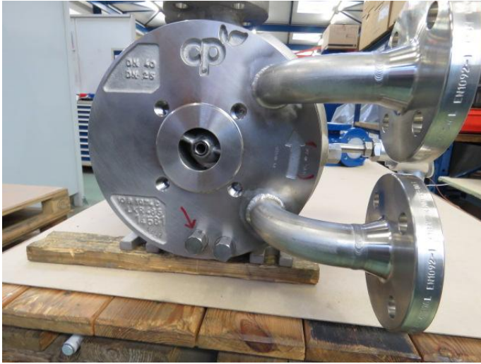
Bouchon de vidange pour MKP avec chambre de réchauffage: Situation normale, monté .
