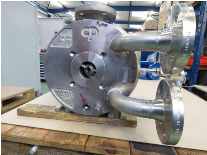
Bouchon de vidange pour MKP avec chambre de réchauffage: démonté
