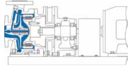
MKP 轴承座式 OH2 HT (高温型) 泵 带中间支撑 -100°C 至 +350°C
