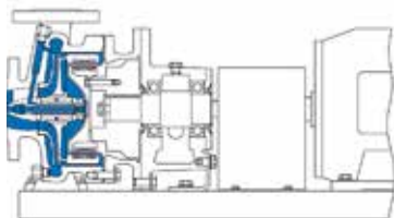
MKP chaise palier avec chassis -100 °C à +250 °C
