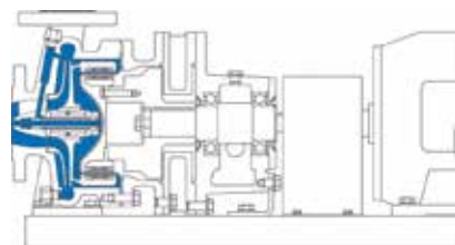
MKP chaise palier OH2 HT (haute température) avec support pattes à l'axe -100 °C à +350 °C
